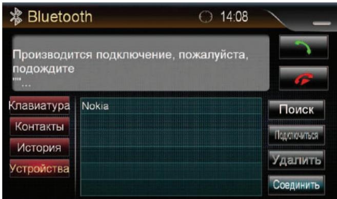
После удачного соединения вашего телефона и головного устройства на экране отобразится имя вашего телефона. В память устройства могут быть внесены несколько телефонов, выберите необходимый вам и нажмите «**Подключиться**». Для удаления телефона из памяти выберите название телефона и нажмите «**Удалить**»
