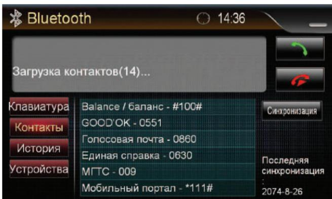
Для синхронизации телефонной книги нажмите «**Контакты**», затем «**Синхронизация**». Доступные контакты будут скопированы в память головного устройства.
