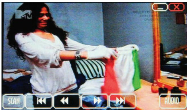
**SCAN** нажмите для начала сканирования. ТВ тюнер просканирует диапазон и запишет ТВ программы в память.
