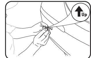
6. вставьте датчик в отверстие и вдавите внутрь
