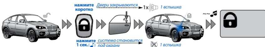
При постановке на охрану система осуществляет контроль всех тревожных зон, обеспечивает запирание замков дверей и блокировку двигателя.
