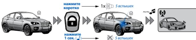
Для того чтобы облегчить поиск своего автомобиля на крупной автостоянке, коротко нажмите на кнопку во время, когда автомобиль находится под охраной, система выдаст 5-кратный звуковой сигнал сирены и пять вспышек указателей поворота.
