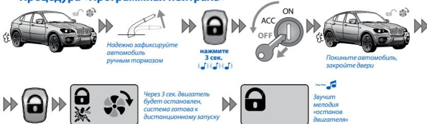
В случае если предполагается использовать дистанционный или автоматический запуск двигателя на автомобиле с МКПП, то перед постановкой автомобиля на охрану необходимо выполнить следующую последовательность действий:
