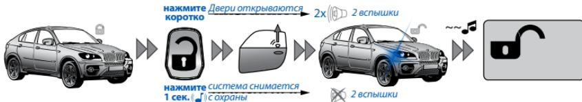
Для снятия системы с охраны коротко нажмите на кнопку брелока, при этом Вы услышите два коротких звуковых сигнала и увидите две вспышки указателей поворотов, брелок проиграет мелодию «снятие с охраны», пиктограмма состояния системы охраны примет вид:
