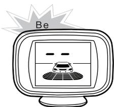
Включите зажигание, переместите ручку коробки передач из позиции N в позицию R 10 раз с интервалом в 1 сек. На 10-ый раз останьтесь в позиции R на 6 сек. Это активизирует функцию запоминания и система больше не будет реагировать на выносной элемент автомобиля.
