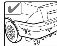
Пожалуйста, очищайте датчики ото льда с помощью горячей воды, продуйте датчики сжатым воздухом для удаления влаги
