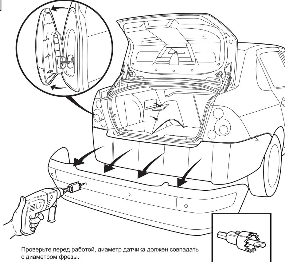
Проверьте перед работой, диаметр датчика должен совпадать с диаметром фрезы.
