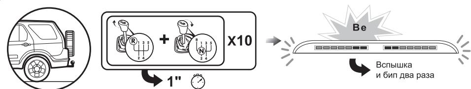
Включите зажигание, переместите ручку коробки передач из позиции N в позицию R 10 раз с интервалом в 1 сек. На 10-ый раз останьтесь в позиции R на 6 сек. Это активизирует функцию запоминания и система больше не будет реагировать на выносной элемент автомобиля. Включите зажигание, переместите ручку коробки передач из позиции N в позицию R 12 раз с интервалом в 1 сек. На 12-ый раз останьтесь в позиции R на 8 сек. Это обнулит функцию запоминания.
