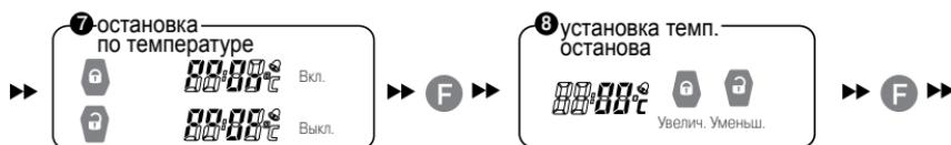
Максимальная температура останова двигателя, во избежание установки недопустимого значения пользователем, может быть ограничена программно (подуровни II-6.2.-6.4 меню программирования руководства по монтажу) до 60, 80 или 105°С ( заводская установка 105°С).
