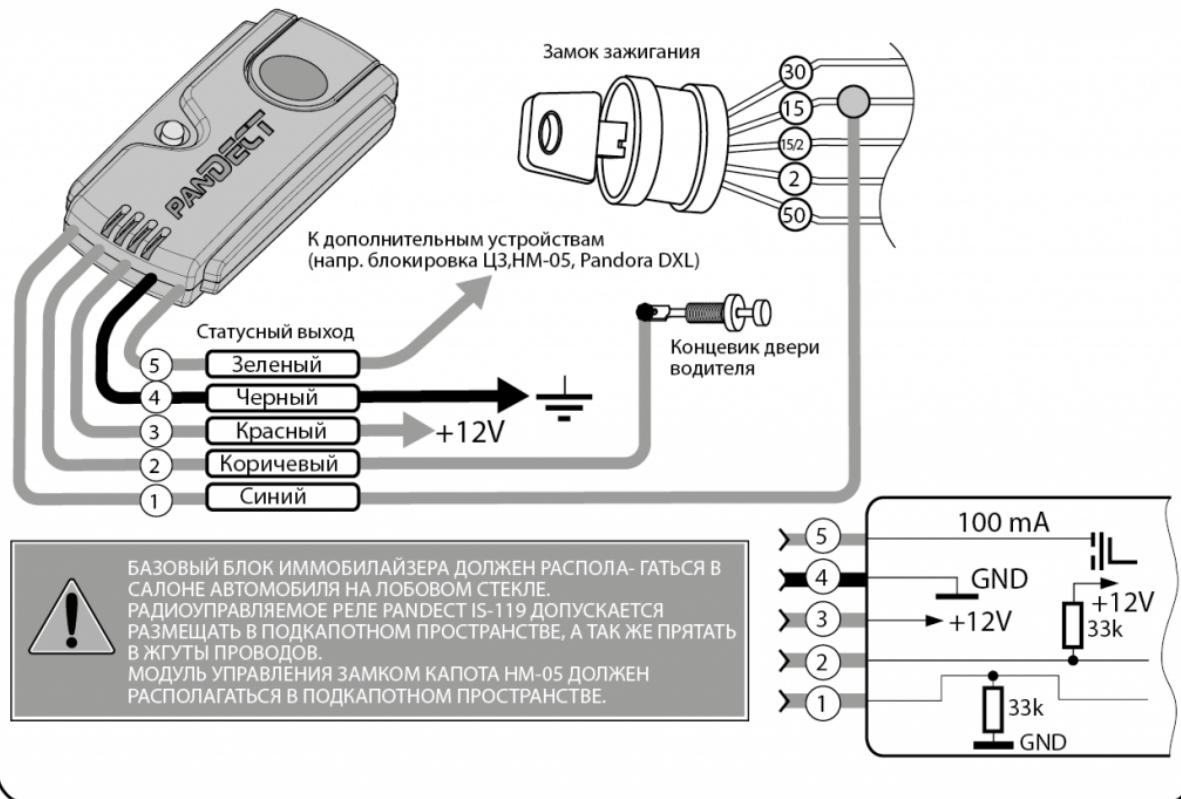
**Провод «4» (Черный) («Масса»)** базового блока должен быть присоединен к кузову автомобиля или надежному проводнику, соединяющему кузов и какой-либо штатный потребитель. Данный провод подсоединяется при монтаже в первую очередь.
