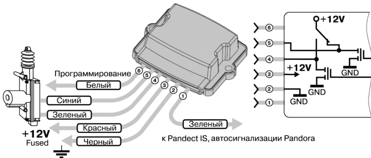
**Провод «1» (зеленый)** модуля управления должен быть присоединен к управляющему проводу (зеленый) (CH4) базового блока автосигнализации **Pandora**.
