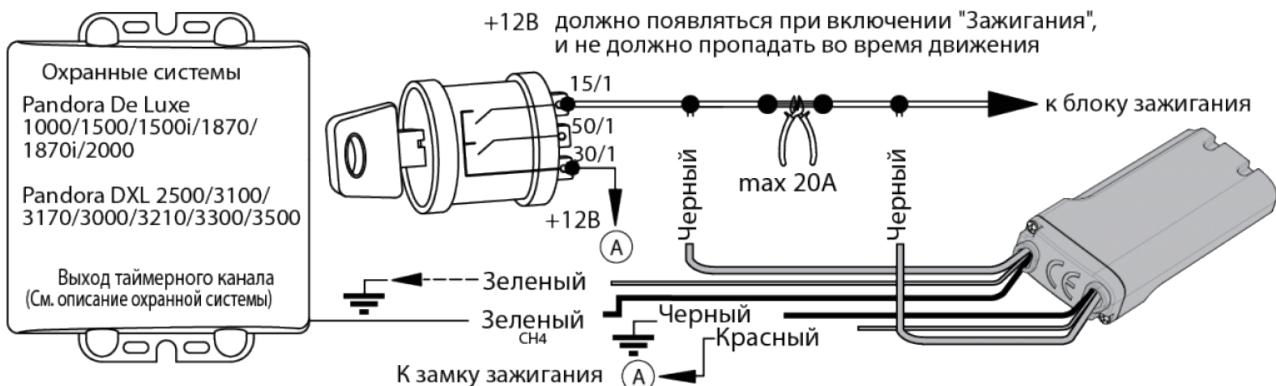
В режиме программирования "Зеленый" провод соединить с "Массой" таймерного канала,
