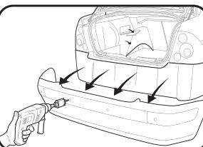
4. просверлите посадочные отверстия, демонтируйте бампер. Толщина бампера не должна превышать 4,5 мм
