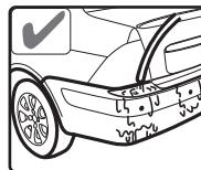
очищайте датчики ото льда с помощью горячей воды, продуйте датчики сжатым воздухом, для удаления влаги
