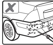
мойте датчики под низким давлением воды, после мойки, продуйте датчики сжатым воздухом, для удаления влаги
