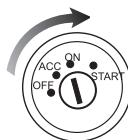
Парковочные датчики переднего контура работают постоянно (при включенном зажигании и выключенной задней передаче)
