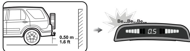
При программировании функции запоминания все ультразвуковые датчики должны быть подключены к системе. Если при программировании какой-либо датчик был отключен, то при его дальнейшем подключении индикатор будет показывать постоянное наличие препятствия по соответствующему каналу. Данная ошибка устраняется повторным перепрограммированием системы со всеми датчиками.
