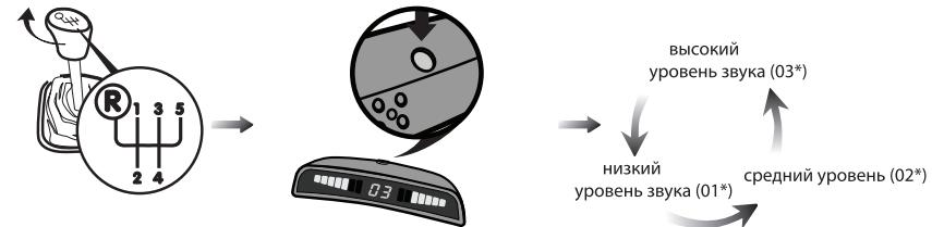
Включите зажигание и кратковременным нажатием на кнопку регулировки громкости звука выберете необходимый уровень громкости.
