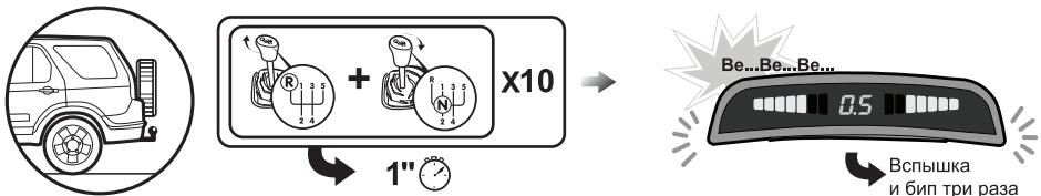
Дисплей просигнализирует световой индикацией и прозвучит тройной звуковой сигнал. Это означает, что функция запоминания прошла успешно и система не будет реагировать на выносные элементы.
