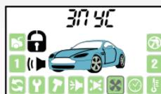
затем - индикация работающего двигателя и оставшегося времени работы двигателя:
