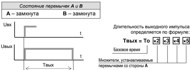
**Пример** Пусть имеется таймер T6.1 с  $T_0 = 1$  сек. Для получения выходного импульса с длительностью 15 секунд необходимо удалить переключки **x3** и **x5** со стороны **A** ( $T_{\text{вых}} = 1 \text{сек} \times 3 \times 5 = 15$  секунд)
