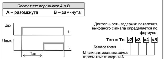
Если длительность входного импульса меньше времени задержки  $T_{\text{зп}}$ , выходной сигнал ( $U_{\text{вых}}$ ) не формируется.
