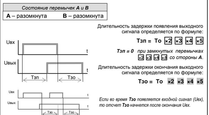
**Пример** Пусть имеется таймер T6.1 с  $T_0 = 1$  сек. Для получения выходного сигнала с  $T_{\text{зп}} = 2$  сек. и  $T_{\text{зо}} = 3$  сек. необходимо удалить переключки: **x2** со стороны **A** ( $T_{\text{зп}} = 1 \text{сек} \times 2 = 2$  секунды) **x3** со стороны **B** ( $T_{\text{зо}} = 1 \text{сек} \times 3 = 3$  секунды)
