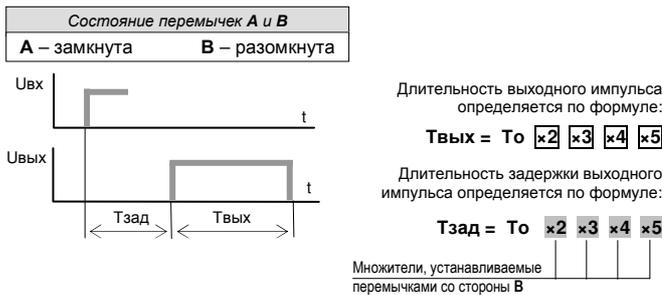
Формирование выходного сигнала ( $T_{\text{зад}}$  и  $T_{\text{вых}}$ ) происходит по началу входного импульса и не зависит от его длительности.
