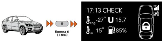
Для получения информации о температуре двигателя, салона, напряжения аккумулятора и уровня топлива (зависит от автомобиля) необходимо нажать и удержать в течение 1 сек. кн. б. Для выхода из режима коротко нажмите кнопку F или выход произойдет автоматически через 10 сек.
