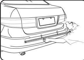
3. разделите отмеченную точками горизонтальную линию на три отрезка и отметьте средние точки
