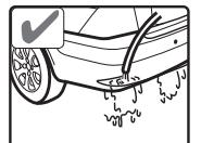
Пожалуйста, мойте датчики под низким давлением воды, после мойки продуйте датчики сжатым воздухом для удаления влаги.
