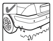
Пожалуйста, очищайте датчики от льда с помощью горячей воды; продуйте датчики сжатым воздухом для удаления влаги.
