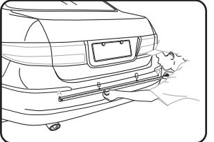
3. разделите отмеченную точками горизонтальную линию на три отрезка и отметьте средние точки
